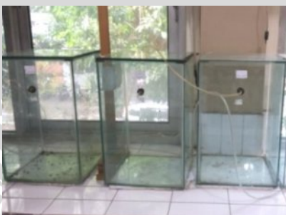
Gambar Lampiran 2. Kotak Uji Preferensi Alat Olfaktometer
