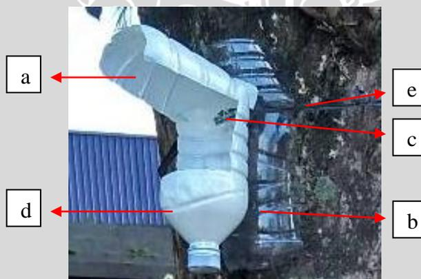
Gambar 12. Desain perangkat (a: atap perangkat, b: pembatas perangkat dengan pohon, c: gantungan etanol, d: bagian pengumpul serangga, e: tali rafia).
