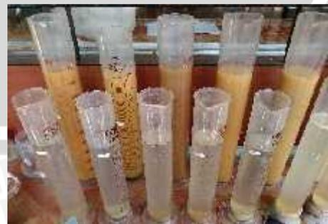
Gambar 9. Uji Laboratorium Tekstur Tanah
