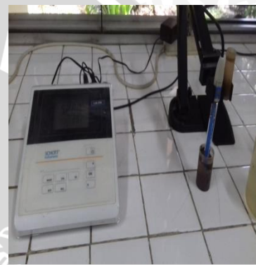
Pengujian pH dengan pH meter
