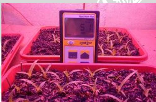
Gambar 22. Pengukuran Intensitas Cahaya MBM dengan PAR-meter
