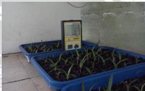
Gambar 21. Pengukuran Intensitas Cahaya Matahari dengan PAR-meter
