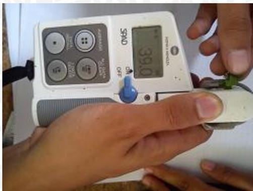
Gambar 30. Pengukuran Indeks Klorofil dengan Klorofil-meter
