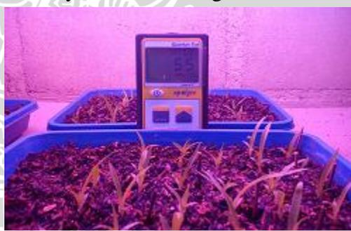
Gambar 23. Pengukuran Intensitas Cahaya BMB dengan PAR-meter
