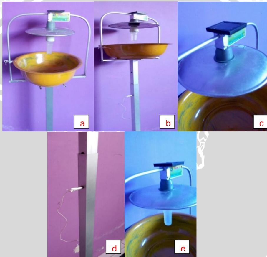
Gambar 5. Desain Lampu Perangkat LED (a) Desain lampu perangkat bagian atas; (b) Desain lampu perangkat keseluruhan; (c) Panel surya; (d) Tiang pengatur ketinggian; (e) Lampu LED
