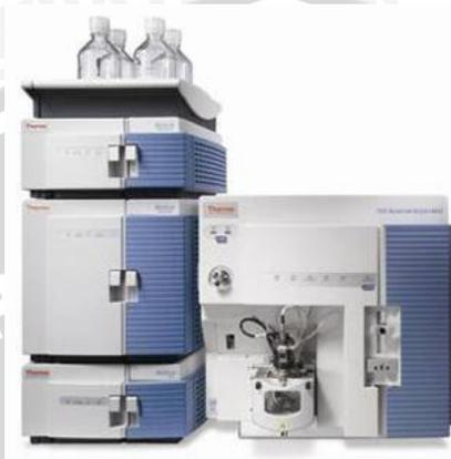
Gambar 7. Alat Analisis Mass Spec merk Thermo Scientific seri LC ACELLA 1250 dengan sistem Triple Quadrupole
