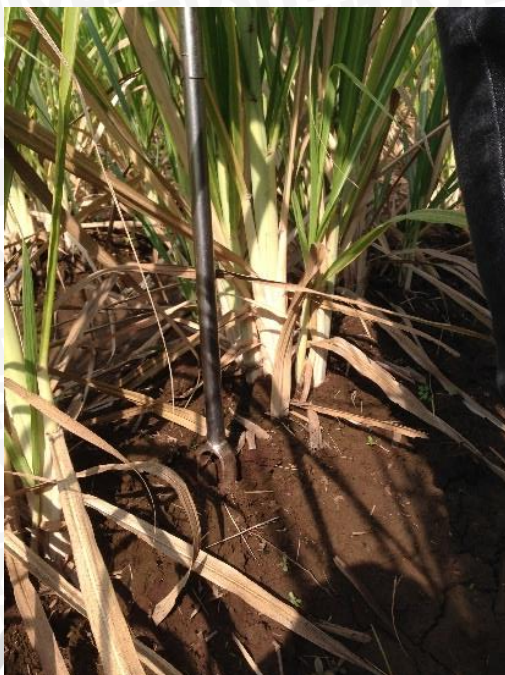
Pengambilan Contoh Tanah menggunakan Bor Tanah
