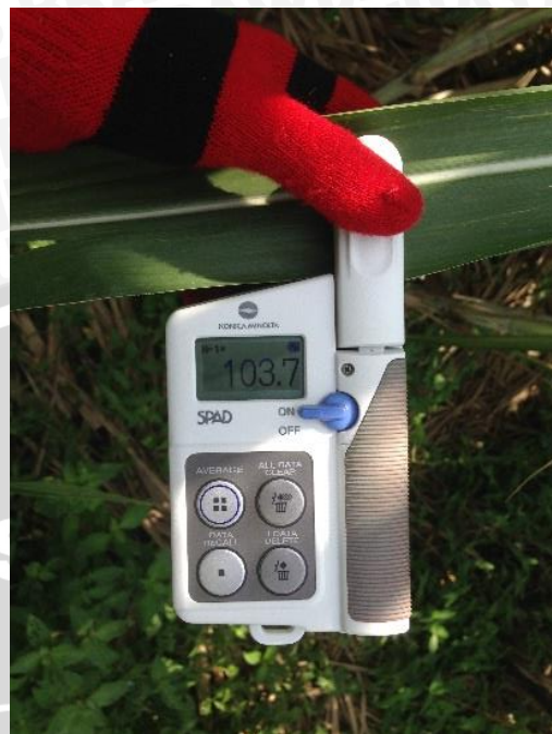
Pengukuran Klorofil dengan SPAD
