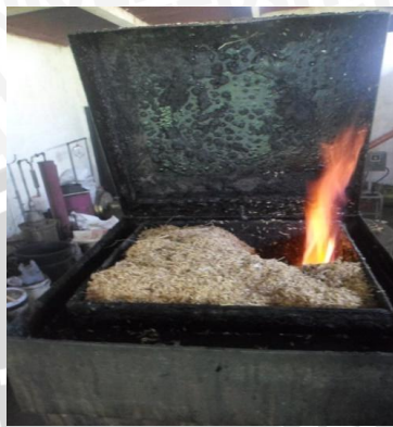
Proses pembakaran limbah biomassa di dalam reaktor
