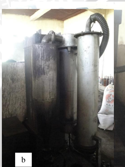
Gambar 3. Satu Set Alat Pirolisis yang Digunakan dalam Pembuatan Biochar : a. Alat Pirolisis Tampak dari Depan, b. Alat Pirolisis Tampak dari Belakang.
