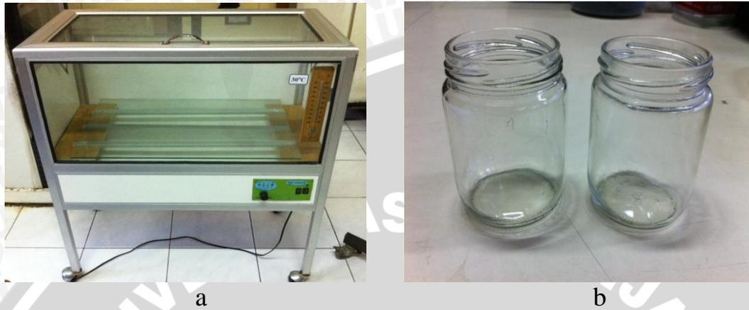
Gambar 8. Alat yang Digunakan dalam Penelitian. a. Inkubator Untuk Perlakuan Suhu 30°C, 35°C dan 40°C b. Tabung Penelitian yang Digunakan Dalam Perlakuan Suhu Ruang
