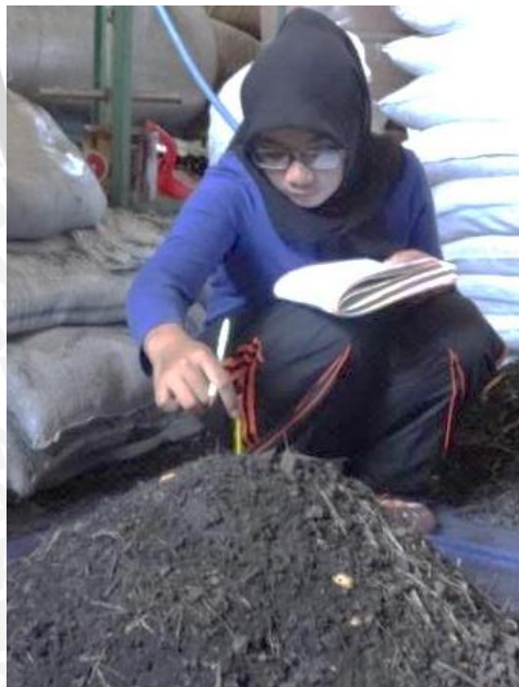
e. Pengukuran suhu untuk mengetahui kematangan kompos
