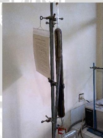
Gambar 26. Tabung Rotary yang Terhubung ke Selang Air Pendingin
