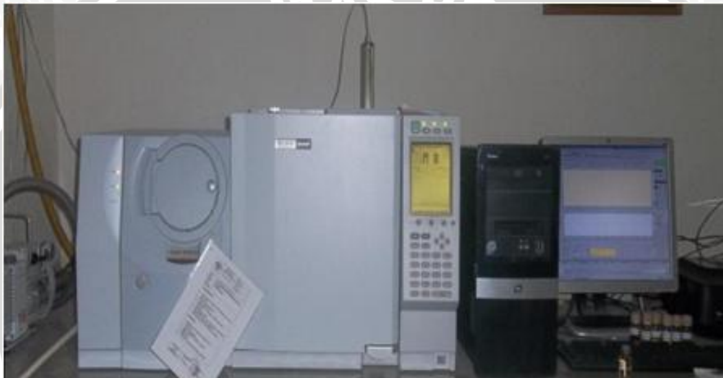
Gambar 9. Satu set alat GC- MS merek Shimadzu QP 2010 S yang digunakan untuk analisis komposisi minyak serai wangi.
