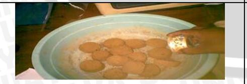
13. Tanah setelah di oven dan di timbang
