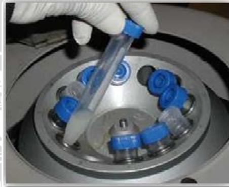
3. Tanah disaring dengan saringan 4 tingkat di bawah air kran yang mengalir 4. Hasil penyaringan di saringan ke-3 dan ke-4 diberi larutan gula 60% sebanyak 5 ml dan di sentrifuse
