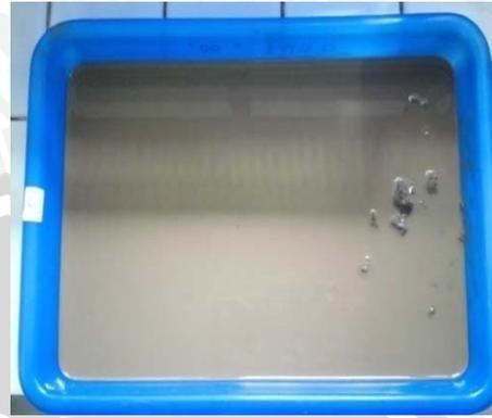
1. Sampel tanah ditimbang seberat 100 gram 2. Tanah dilarutkan dengan air
