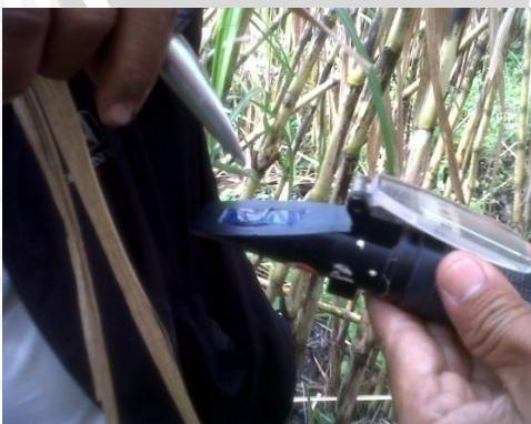
Gambar 12. *Hand refractometer* (alat ukur kadar brix)
