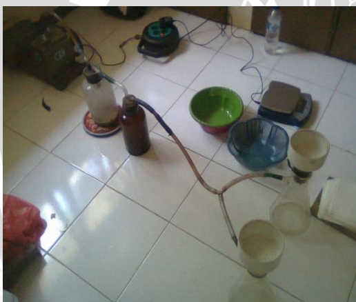
Gambar 5. Alat untuk mengekstraksi pati dan serat kasar umbi ubi jalar (Corong Penghisap).
