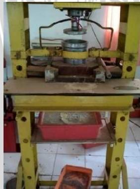
Gambar12. Kantong Pengempa Pasta    Gambar 13. Alat Pengempa Pasta Cokelat
