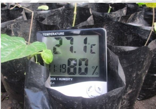
Gambar 9. Pengukuran Suhu dan Kelembaban Menggunakan Alat Thermohygrometer
