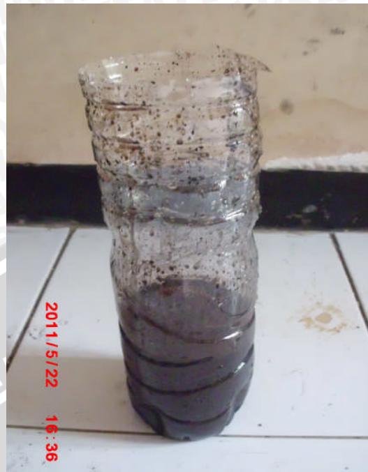
Gambar Lampiran 7. Hasil akhir dari pembuatan asap cair dengan menggunakan Pirolisator, pada saat pengambilan hasil akhir dilakukan penampungan tetesan asap cair pada ujung pipa pendingin Pirolisator, saat pembakaran berlangsung.
