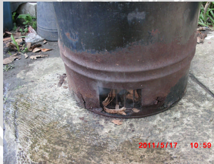
Gambar Lampiran 2. Lubang di tungku pembakaran yang berfungsi sebagai sirkulasi udara saat pembakaran tempurung kelapa berlangsung
