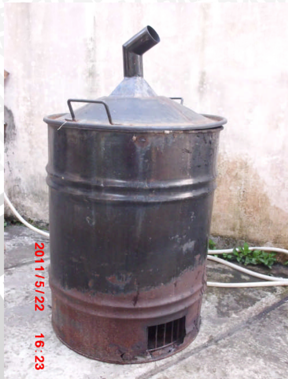
Gambar Lampiran 3. Tungku pembakaran dari Pirolisator yang sudah ditutup menggunakan penutup dengan cerobong saluran asap di atasnya.
