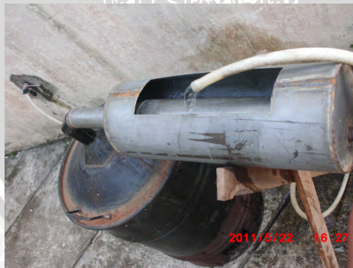
Gambar Lampiran 4. Cerobong asap pada tutup pirolisator yang sudah terhubung dengan pipa penyalur asap, pada bagian tengah pipa terdapat penampung air yang berfungsi sebagai pendingin asap setelah penampung air tersebut terisi air.
