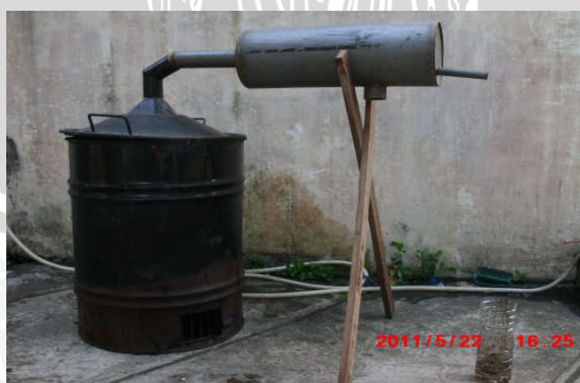
Gambar 1. Alat yang digunakan untuk pembuatan asap cair dari tempurung kelapa, alat tersebut dinamakan Pirolisator.
