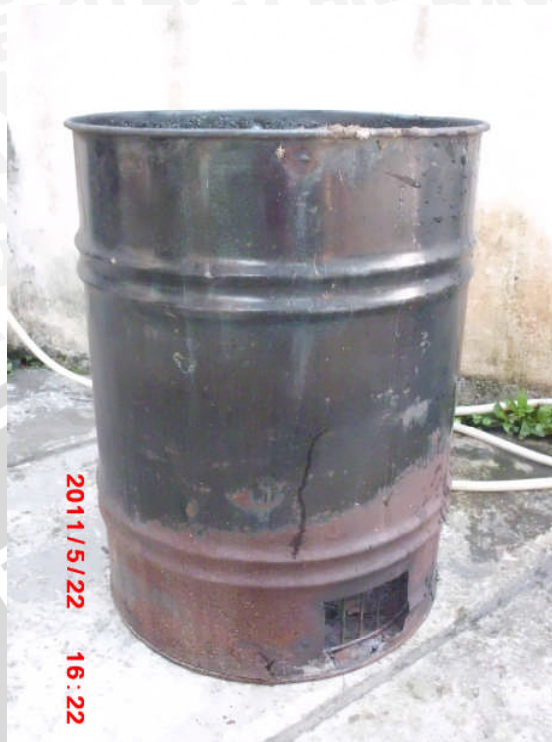
Gambar Lampiran 1. Bagian tungku pembakaran dari alat Pirolisator
