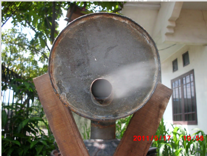
Gambar Lampiran 6. Bagian ujung pipa pendingin Pirolisator saat proses pembakaran tempurung kelapa berlangsung
