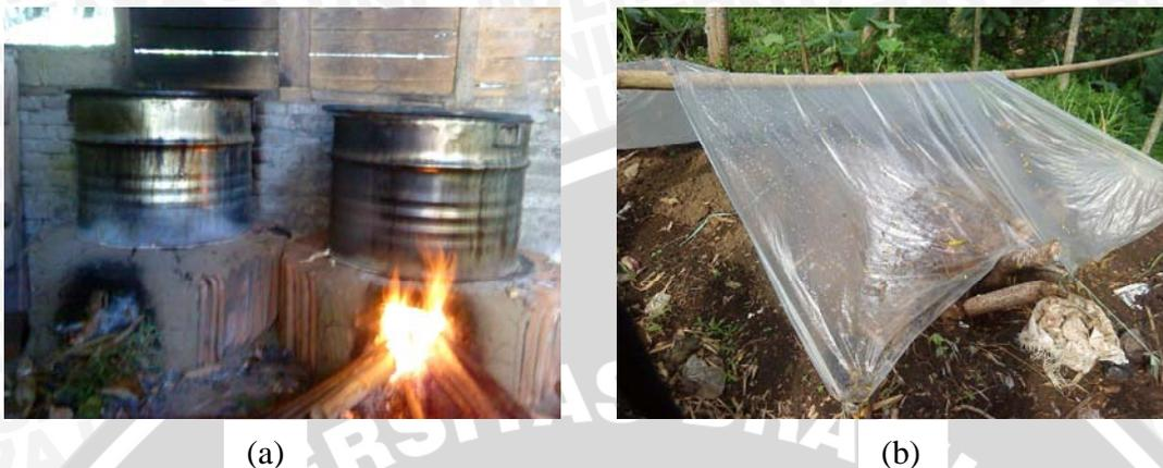
Gambar 3 : Pembuatan biochar secara konvensional yaitu dengan tungku (a) dan galian tanah (b)
