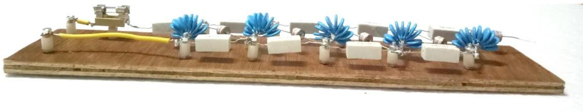
Gambar 4.3 Foto alat *Marx generator* yang telah selesai di gabungkan (tampak samping)
