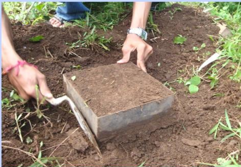
Pengambilan contoh cacing tanah menggunakan bingkai besi ukuran 20x20x10 cm
