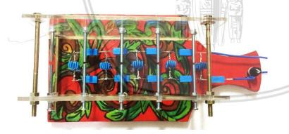
Gambar 5.1. Rangkaian Marx Generator Pengujian Pertama Tanpa Beban
