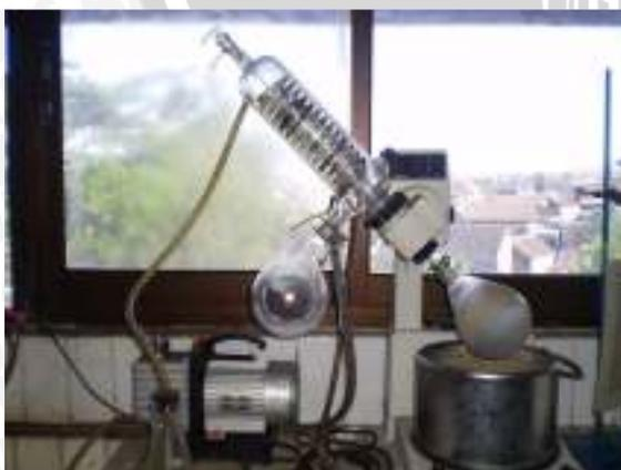
Gambar 5. Evaporator untuk memisahkan senyawa allelopat dengan alcohol
