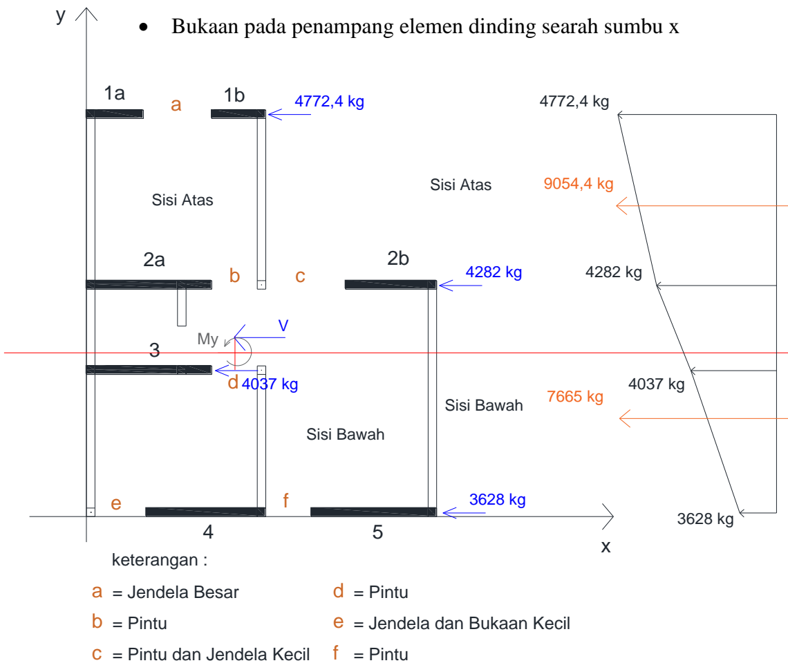
Gambar 4.60 Distribusi gaya geser pada elemen dinding denah C searah sumbu x
