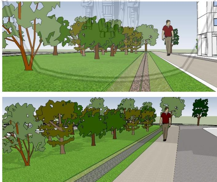
Gambar 4.29 Kondisi *swales* kering dan basah (terisi air hujan)
