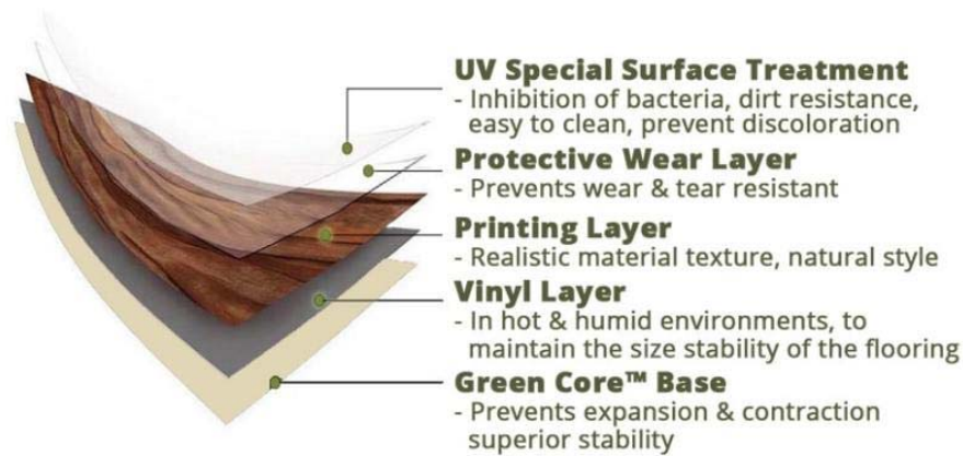
Gambar 4.38 Struktur pemasangan material pada lantai (Sumber: https://www.meiganflooring.com/meigan/ , 2018)
