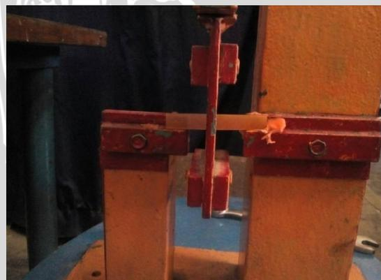
Gambar 4.2 Alat Uji Kekuatan Impak *Charpy*
