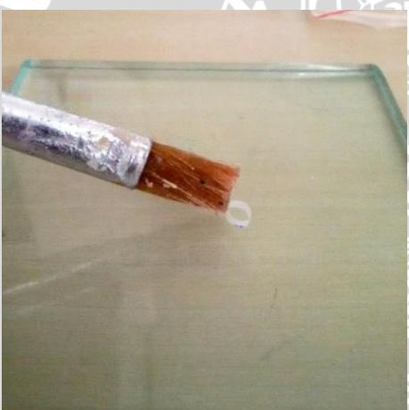
3. Peletakan celluloid strip dan label plastik pada dasar cetakan
