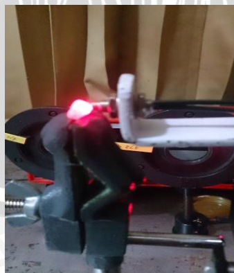
Gambar 4.1 Pengukuran translusensi enamel gigi sulung hasil penelitian menggunakan Spectrofotometer
