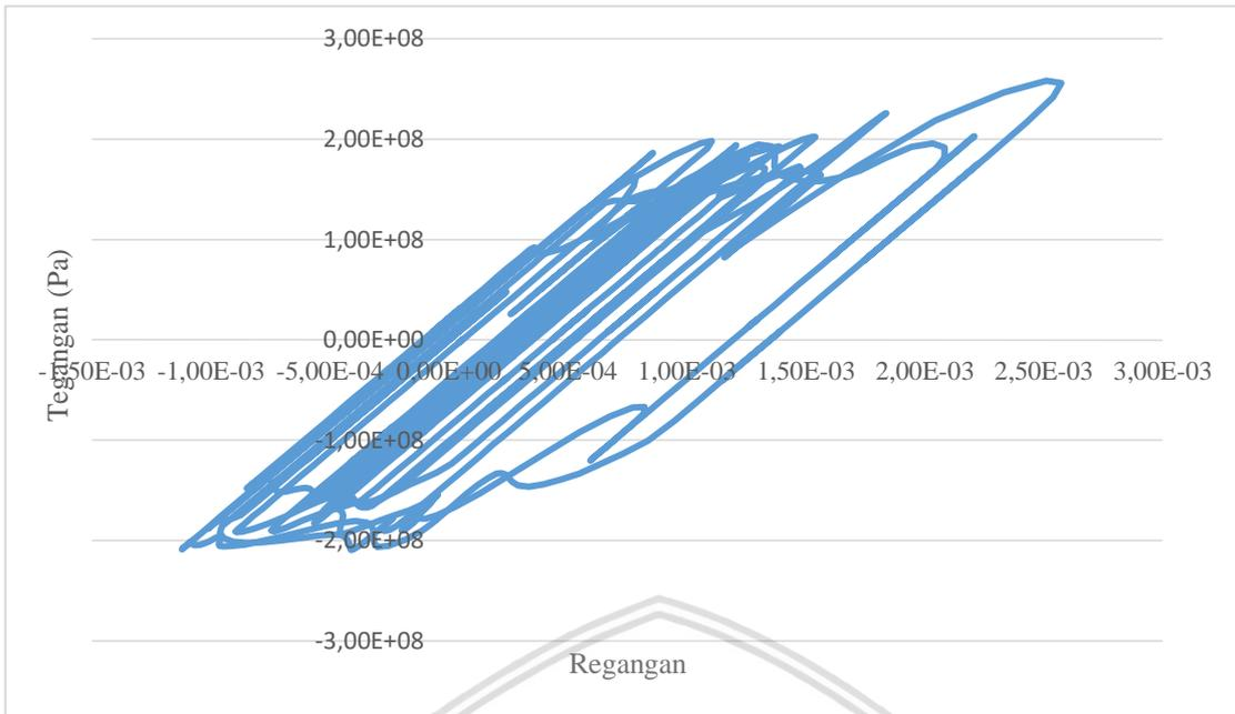
Gambar 4.38 Grafik hubungan tegangan-regangan pada batang dekat tumpuan sendi
