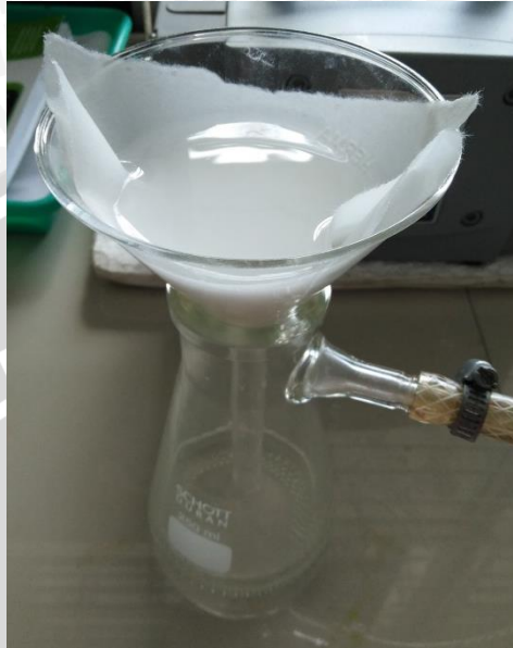
Proses filtrasi hasil modifikasi cross-linking pati kentang menggunakan vacuum filter
