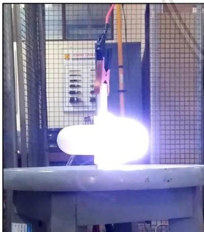
*Gambar 4.12 Flashover* pada Isolator Tipe A
