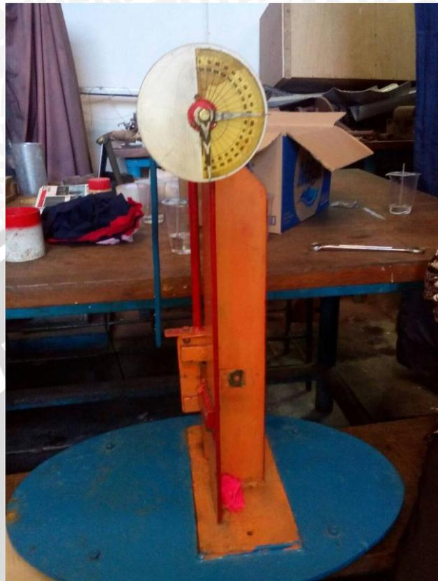
Gambar 3 : Alat uji kekuatan impak Charpy (Sumber : Laboratorium Korosi dan Kegagalan Material, jurusan Material Metalurgi ITS)
