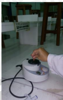
Campuran diaduk dengan vibrator agar homogen.
