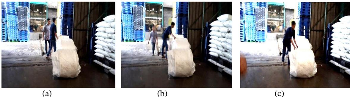
Gambar 1.2 Contoh pemborosan gerakan pada proses pemindahan *roll sheet*
