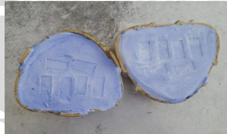
Mold yang siap digunakan sebagai cetakan akrilik
