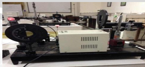
Gambar 4.1 Alat pengukur intensitas cahaya , terdiri dari: a). Spektrofotometer optik b). Fotosel BPY-47 c). Microvolt digital
