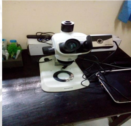
Gambar L.2.1 Mikroskop Stereo Olympus SZ60
