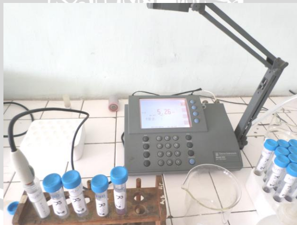
Gambar 5.2 Pengukuran pH Saliva Buatan Menggunakan pH Indikator
