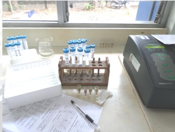
Gambar 5.5 Pengukuran Absorbansi Saliva Buatan Menggunakan Spektrofotometer
