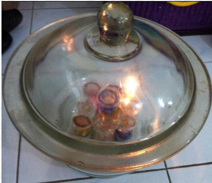
4 Juni 2013 Tabung Anaerob untuk inkubasi, terdapat api untuk memastikan tidak ada lagi Oksigen saat api mati
