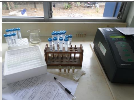
Pengukuran absorbansi saliva sesudah inkubasi 18-24 jam dengan spektrofotometer
