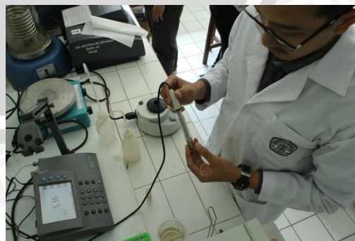
Pembacaan pH campuran dekok dan saliva menggunakan pH meter digital
