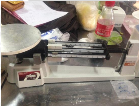
Gambar 5 : timbangan triple beam untuk menyiapkan bahan
