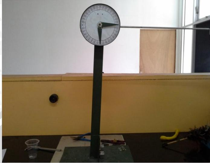
Gambar 4.8 Alat Uji Kekuatan Impak *Charpy Test*
