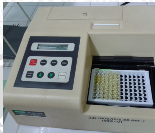
Gambar 22. Pengukuran OD menggunakan ELISA reader
