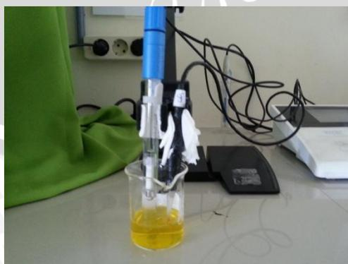
**Gambar 5.2** Pengukuran ESI metanil yellow pada Larutan Kerja
