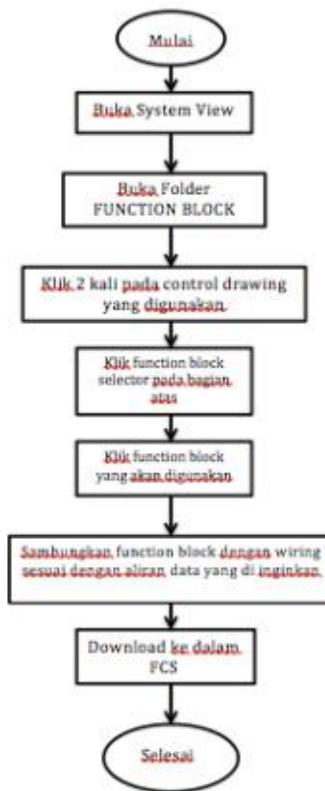
Gambar 3.8 Diagram Alir Pembuatan *Function Block*
