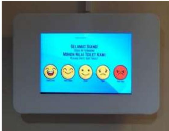
Gambar 4.22 Perangkat keras untuk menilai kepuasan di toilet
